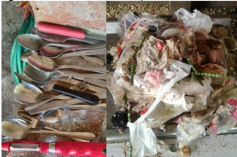
Figura 14. Materiales rechazados susceptibles de causar daños al triturador
