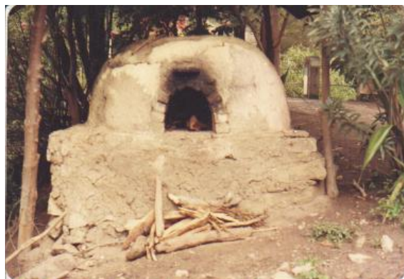
Fotografía 14. Horno para producción de ladrillo y teja de barro en el área rural.
